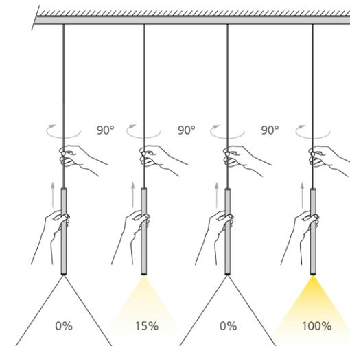
Axiales Drehen von Pendel = Ein / Aus zwei Helligkeitsstufen (100 % oder 15 %)
