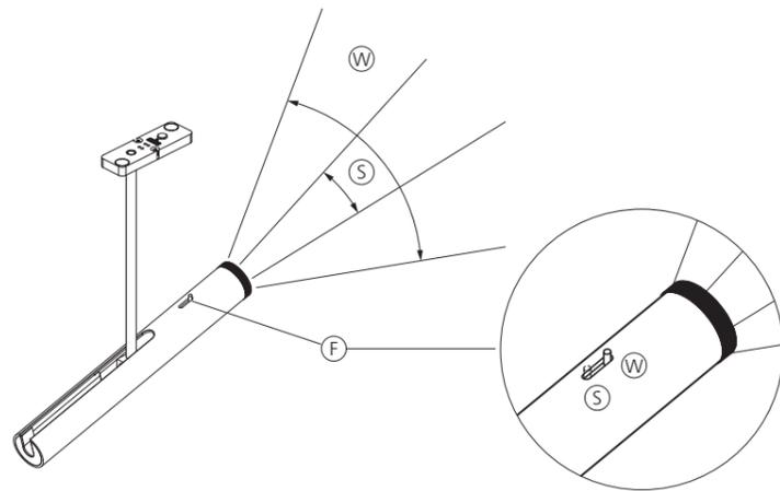
Der Ausstrahlwinkel kann durch den verschiebbaren Fokussierstift angepasst werden.
