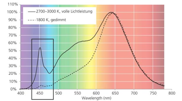
Lichtspektrum bei Volllicht mit 2700–3000 K und bei minimaler Helligkeit mit 1800 K
