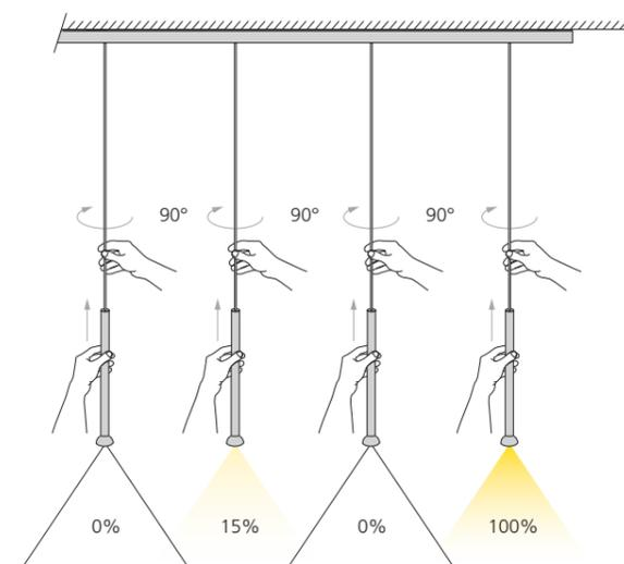
Axiales Drehen von Pendel = Ein / Aus zwei Helligkeitsstufen (100 % oder 15 %)
