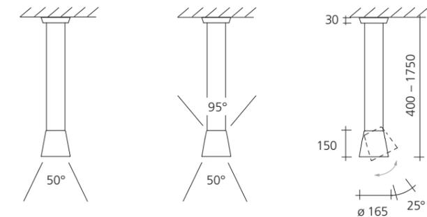
Direktlicht → umschalten → Direkt- und Indirektlicht
